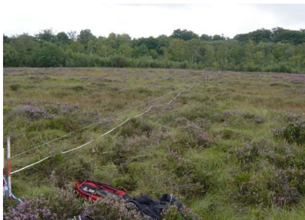
Figur 10.3. 100-metertransekt på Holmegård Mose i 2004 med snor til opmåling af overfladerelief.
